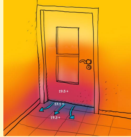
Kapı altından giren soğuk havanın ısı fotoğrafı
