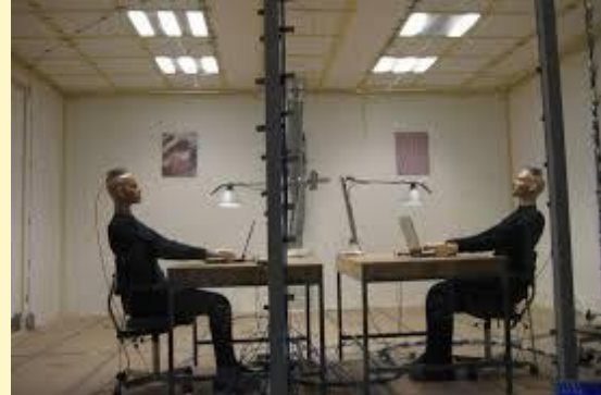
Isıl konfor test odası ve insansı test modelleri 10
