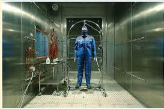
Bir iklim odasında ısı konfor deneyleri için insansı manken (manikin) 9
