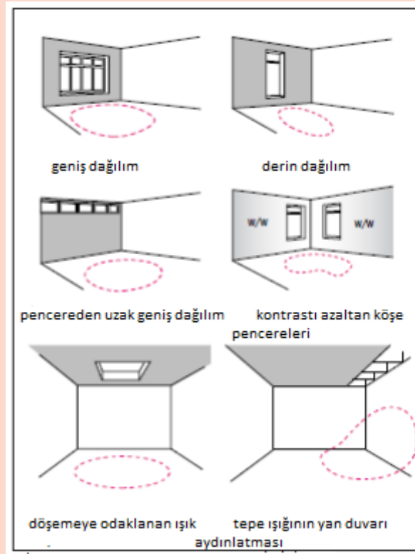
Şekil 3. Pencere tasarımı ve çatı açıklıkları değişikliğiyle aydınlık düzeyi ve ışık dağılımı değişimi.
